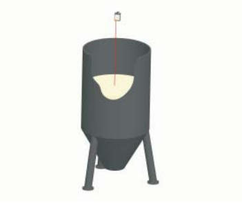
Mesure de niveau de silos
